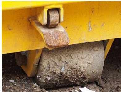
荷重を支えるロールにはS45Cを採用。耐摩耗や衝撃を吸収。荷卸し等の作業時にコンテナBOXと設置する路面も傷めにくい構造。
