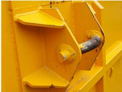
荷重が多いフロントフックにはS25Cを採用。フックの丸棒だけでなく取付部全体を強度アップした設計。
